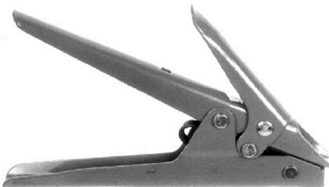
Рис.1. Инструмент для затяжки стальных хомутов RIL 9
